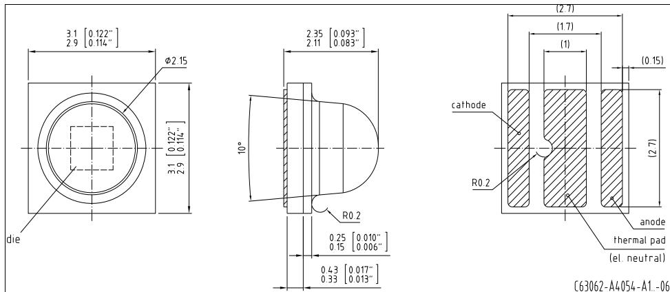
Anm.: Die LED enthält ein ESD-Bauteil, das parallel zum Chip geschalten ist.
